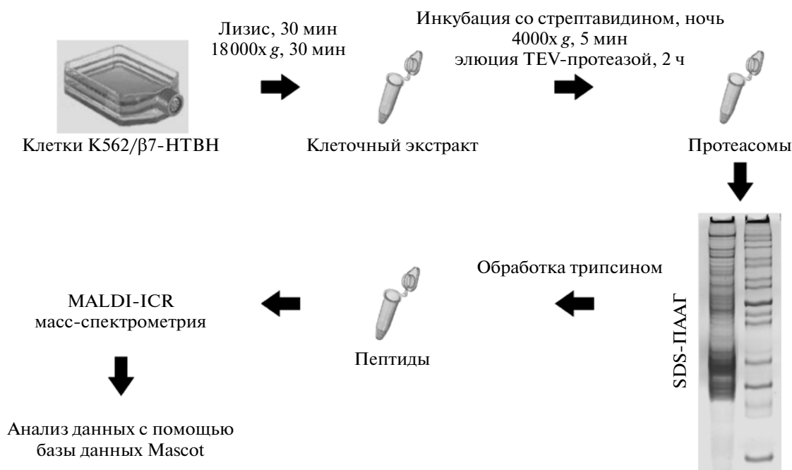
Рис. 2. Схематическое изображение этапов эксперимента, включая очистку протеасом из клеток, разделение протеасомных белков в системе денатурирующего электрофореза и масс-спектрометрический анализ подготовленных проб.
