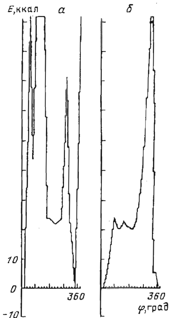
Рис. 5. Изменение структурной энергии молекул R_p - (а) и S_p - (б) диастереомеров амидофосфита (I) при повороте вокруг связи C1_{Cer}-C2_{Cer}
