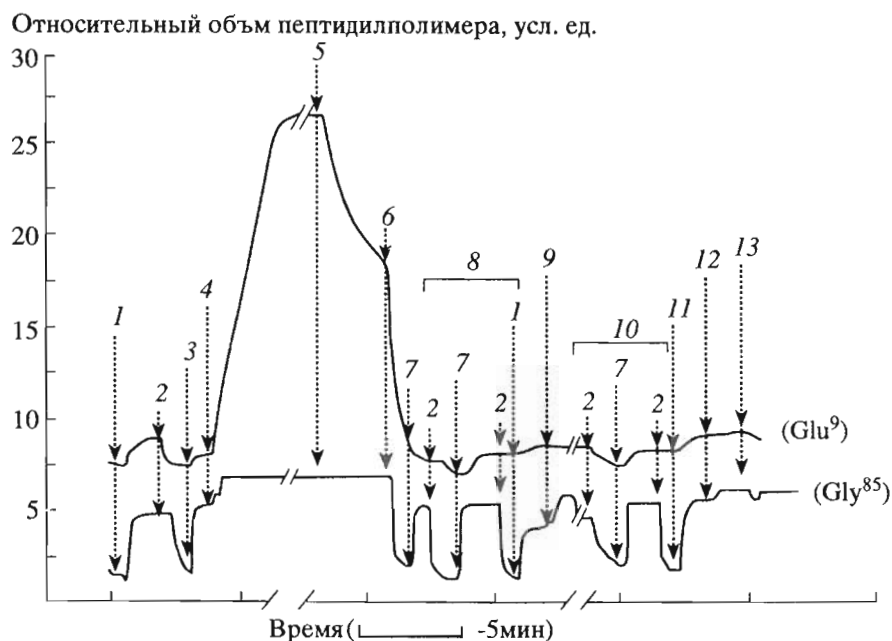
Рис. 2. Светлограммы 2-й ( \text{Gly}^{85} , нижняя кривая) и 69-й ( \text{Glu}^9 , верхняя кривая) стадий второго варианта твердофазного синтеза PDE \gamma . Стрелками обозначены начала шагов синтеза в соответствии с протоколом (табл. 1). Косыми черточками на кривых обозначены разрывы, введенные для совмещения кривых по началам шагов в силу неодинаковой продолжительности одних и тех же шагов на разных стадиях (см. примечание 1 к табл. 1).
